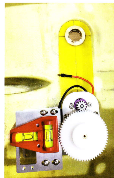
Der Einbau lässt sich sehr gut mit einer Mini-Wasserwaage kontrollieren
