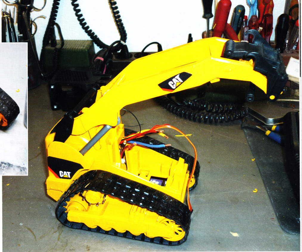
Der Hubarm wurde hier bereits auf den Unterwagen montiert. Die Konstruktion mit einem Servo mit 15 Kilogramm Stellkraft überzeugt
