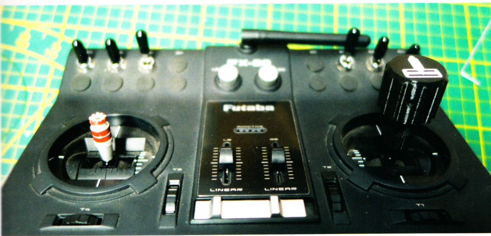
Einmal die originalen Sticks und einmal der neue Drehregler für die Schottelantriebe
